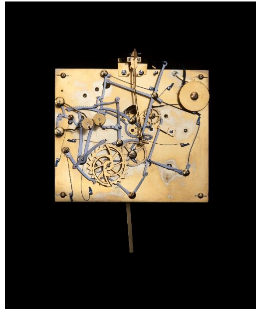
Mouvement de pendule neuchâteloise « Grande sonnerie », « Petite sonnerie » ou « Silence », attribuée à Henri-Louis Maillardet, La Chaux-de-Fonds, vers 1830. Musée d'horlogerie du Locle – Château des Monts © MHL/R. Sterchi (Photo)
